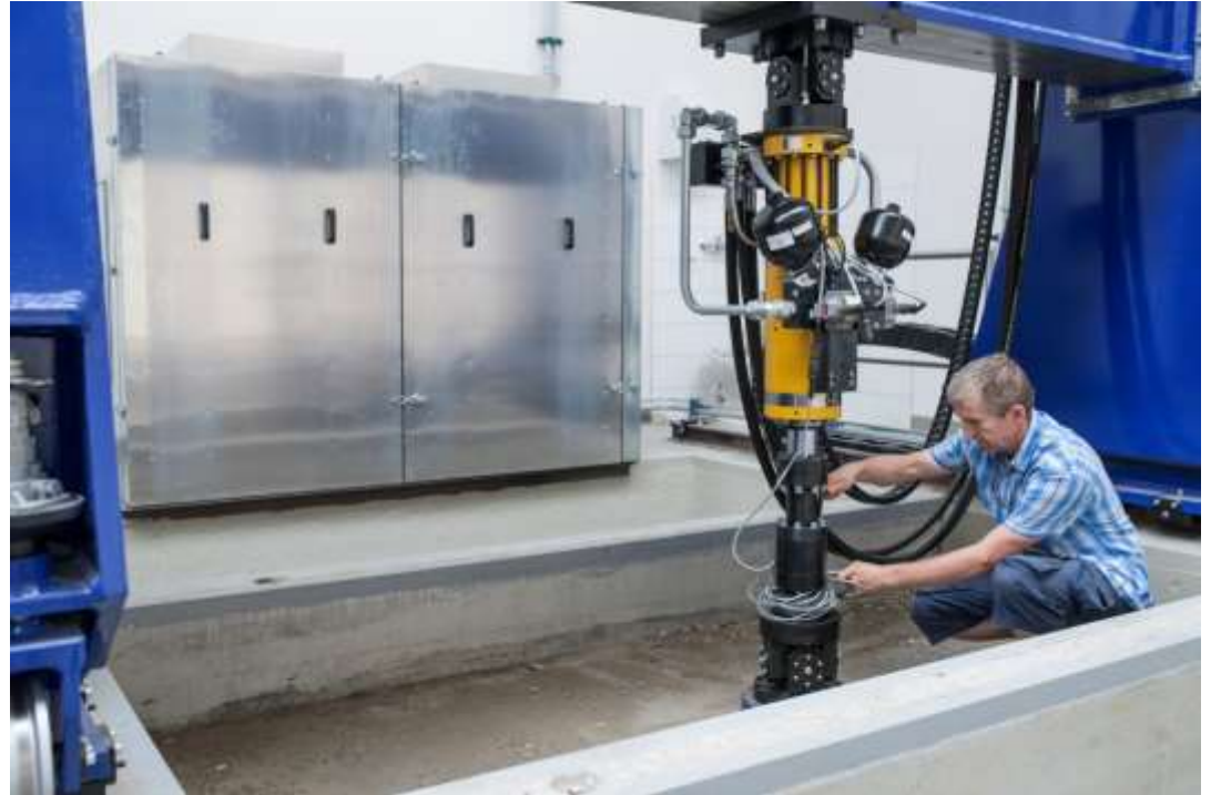
Pneu Tester – cyklické zatěžování konstrukčních vrstev vozovky
