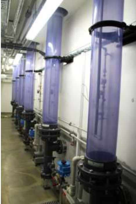
Měřicí válce pro řízení režimu hladiny podzemní vody
